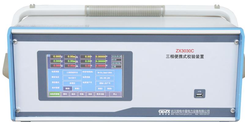
ZX3030C 三相便携式校验装置内置多功能信号发生器,采用 DDS 技术,大规模 FPGA 与 ARM 嵌入式系统组成;能产生 6 路独立可调的输出信号,其中三路电压、三路电流;同时也是装置的主控系统,通过一路 RS232 口与 PC 连接,第二路 RS232 与误差处理系统连接;同时通过 485 通讯口控制电流回路的量程切换,还通过第三路 RS232 口与三相标准表通讯。内置 7 英寸彩色触摸液晶屏,64M 电子存储器,可存储 1000 块电能表的误差数据,模块化的操作功能,友好的人机界面。配置一个 USB 口,可通过 U 盘,对系统升级和导出误差数据,也可外接鼠标进行操作。
