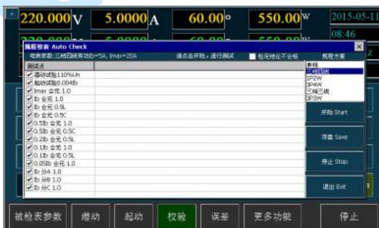
右上方，规程方案中，内置常用的几种电能表方案；按照需要，进行选择；然后按【开始】键，进行自动程控校验，按【保存】键，可对校验数据进行保存。
