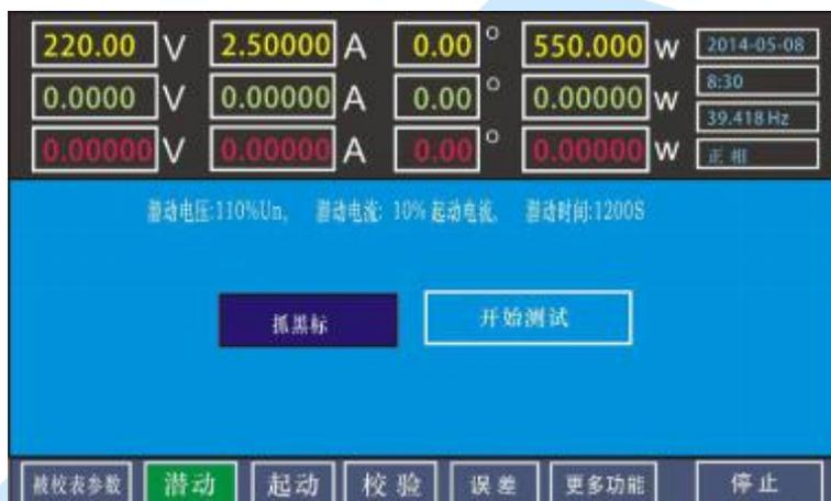
电压调整到 220V, 电流调整到  $5 \times 50\% = 2.5\text{A}$ , 功率源调整结束后; 每个表位显示【-----】, 若抓到黑标, 表位显示【-1-】; 待全部的表位全部完成; 按【停止】键; 结束抓黑标工作。
