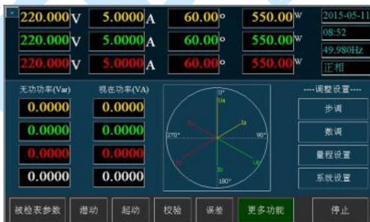
此界面，直接显示 电压、电流、相位、有功功率、无功功率、视在功率以及矢量图。
