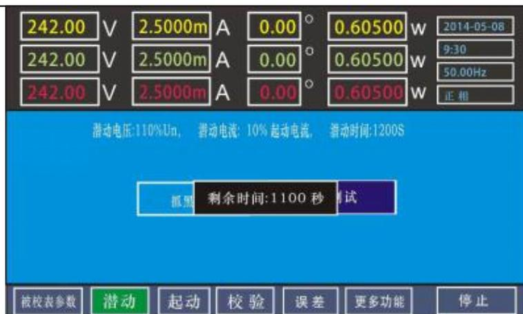
调整结束后；误差显示窗显示‘000000’，设置试验时间进行递减；此时，如电表发出脉冲，则误差显示作递增计数。当试验时间递减到 0 时，装置降电压至额定电压 230V 和降电流为 0；再根据表位的计数值，人工判断电表的潜动试验是否合格，有脉冲数为不合格。建议连接电脑，用软件操作，可自动判断结果。
