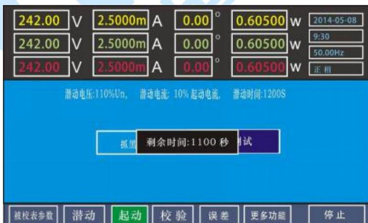
调整结束后；误差显示窗显示‘000000’，设置试验时间进行递减；此时，如电表发出脉冲，则误差显示作递增计数。当试验时间递减到 0 时，装置降电流，再根据表位的计数值，人工判断电表的启动试验是否合格，有脉冲数为合格。建议连接电脑，用软件操作，可自动判断结果。
